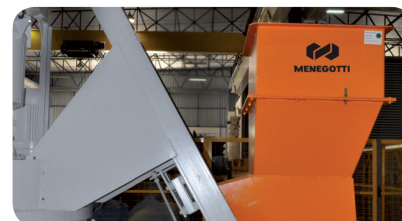
Alimentação por caçamba. Feeding by skip hoist. Alimentación por skip.
