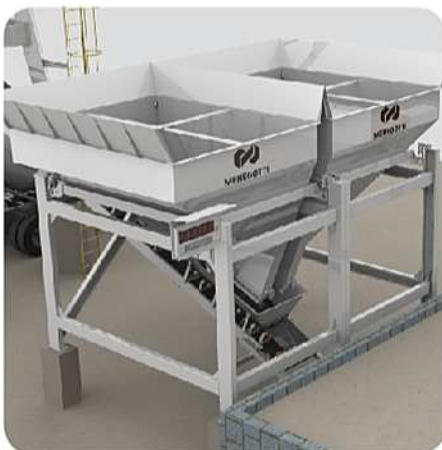
Pesagem de agregados com duas cubas independentes Aggregates weighing with two independent bins Pesaje de agregados con dos cubas
