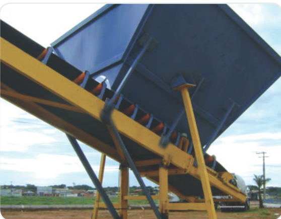
Esteira alimentadora para silos agregados. Feed conveyor for aggregate silos. Cinta alimentadora para silos de agregados.
